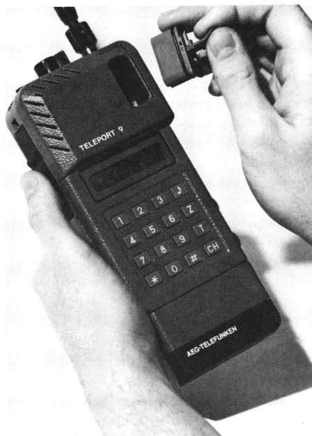
Bild 2: Handfunk-Sprechgerät „Teleport 9“ mit dem Codierstecker Multiprogrammer (AEG-TELEFUNKEN-Pressbild)
