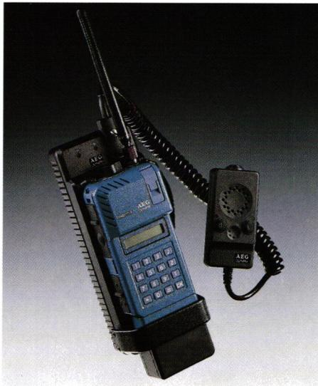
Zum Beispiel Autohalterung und Handmikrofon. Damit machen Sie aus Ihrem Teleport Handfunkgerät im Handumdrehen eine komfortable Mobilfunkanlage.
