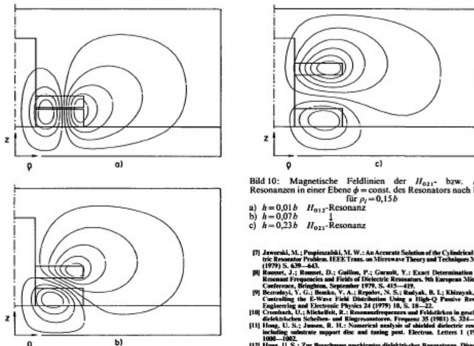
Bild 10: Magnetische Feldlinien der  $H_{011}^+$  bzw.  $H_{011}^-$  Resonanzen in einer Ebene  $\phi = \text{const}$ . des Resonators nach Bild 9 für  $\rho_1 = 0,15b$
